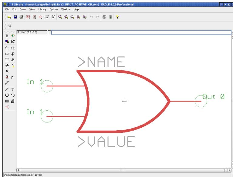
➤ 原理图符号编辑器：逻辑符号（美标表示法）
