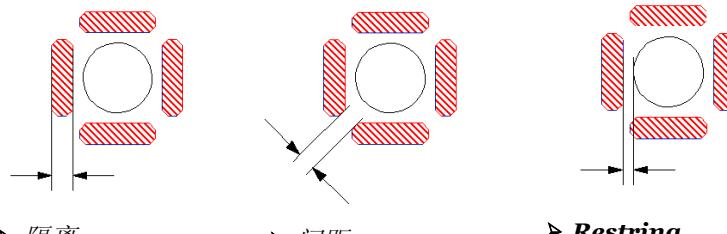
在 Package 编辑器中带有 *NOTHERMALS* (命令 CHANGE THERMALS OFF) 标记的 Pad 或 SMD 一般不会带有 Thermal 连接。
