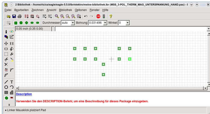
Nun tragen Sie mit dem NAME-Befehl die gleichen Namen (Nummern) in jedes Pad ein wie vorher bei den Pins. Dazu aktivieren Sie den NAME-Befehl und klicken das entsprechende Pad an.
