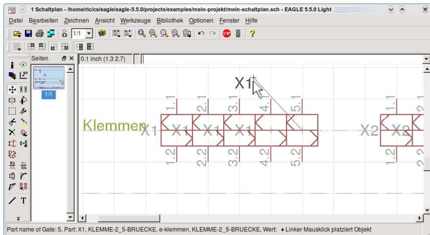
Im nächsten Schritt löschen Sie X1. Klicken dazu mit der rechten Maustaste auf das Kreuz bei X1, mit • auf DELETE im Kontextmenü und X1 ist gelöscht.
