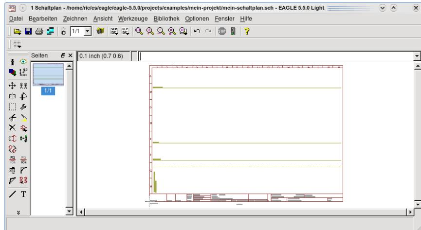
Die grünlichen Hilfslinien in der Zeichnung sollen die optimale Seitenausnutzung erleichtern. Sie können mit dem Display-Befehl ausgeblendet werden, entweder durch Eingabe von
