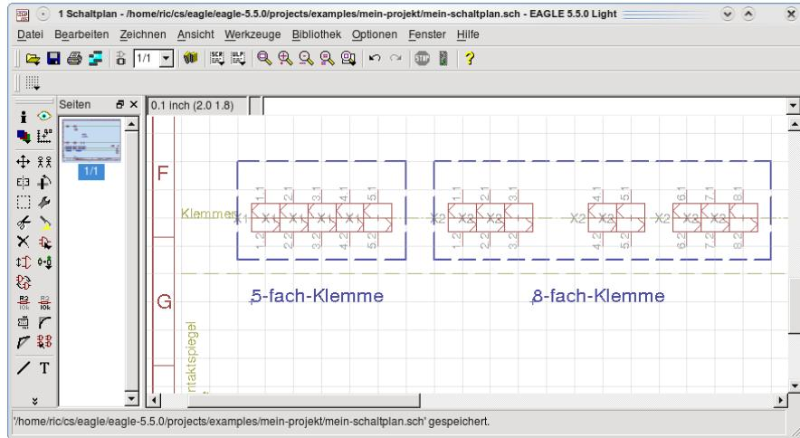
Setzen Sie die Klemmen entsprechend der Reihenfolge in der Vorlage ab. Haben Sie eine andere Reihenfolge, dann tauschen Sie die Klemmen mit MOVE aus.
