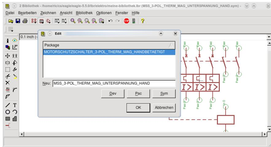
Den anschließenden Warnhinweis *Neues Package erzeugen?* bestätigen Sie mit *Ja*. Der Name müsste nicht unbedingt dem des Symbols und (wie Sie anschließend sehen werden) des Device entsprechen, aber es dient der Übersichtlichkeit.
