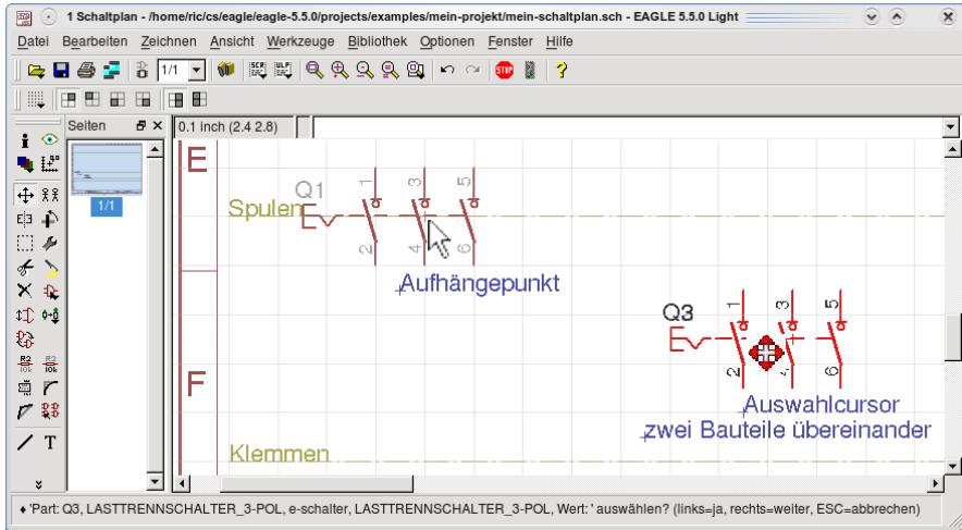
Klicken Sie das Bauteil nochmal an und verschieben Sie es seitwärts. Das Bauteil lässt sich bewegen, hängt aber über ein Netz am ersten Bauteil. Mit zweimal F9 können Sie das zweite Bauteil entfernen (Sie machen damit zwei Platziervorgänge rückgängig).
