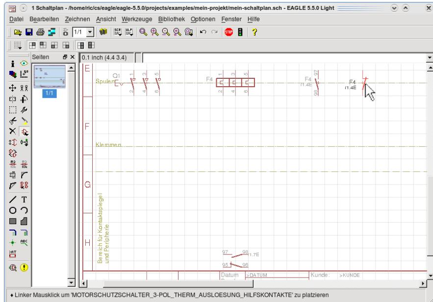
Anschließend mit STOP wie gewohnt das nächste Bauteil entfernen. Diese Vorgehensweise ist immer dann notwendig, wenn die Kontakte einzeln positioniert werden können.
