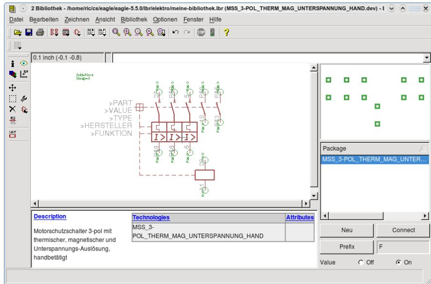
Das Symbol enthält die zeichnerische Darstellung für den Schaltplan (Schaltzeichen). Dazu gehören die Anschluss-Pins (Kontakte) und Platzhalter für den Namen und den Wert (Value). Zusätzlich können noch Platzhalter für Attribute definiert sein, die es ermöglichen, in der Schaltung weitere Eigenschaften (Stromstärke etc.) anzugeben.
