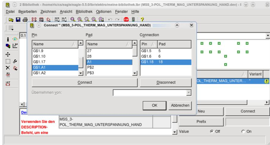
Sind alle Pins mit Pads verbunden, schließen Sie den Dialog mit • auf OK.
